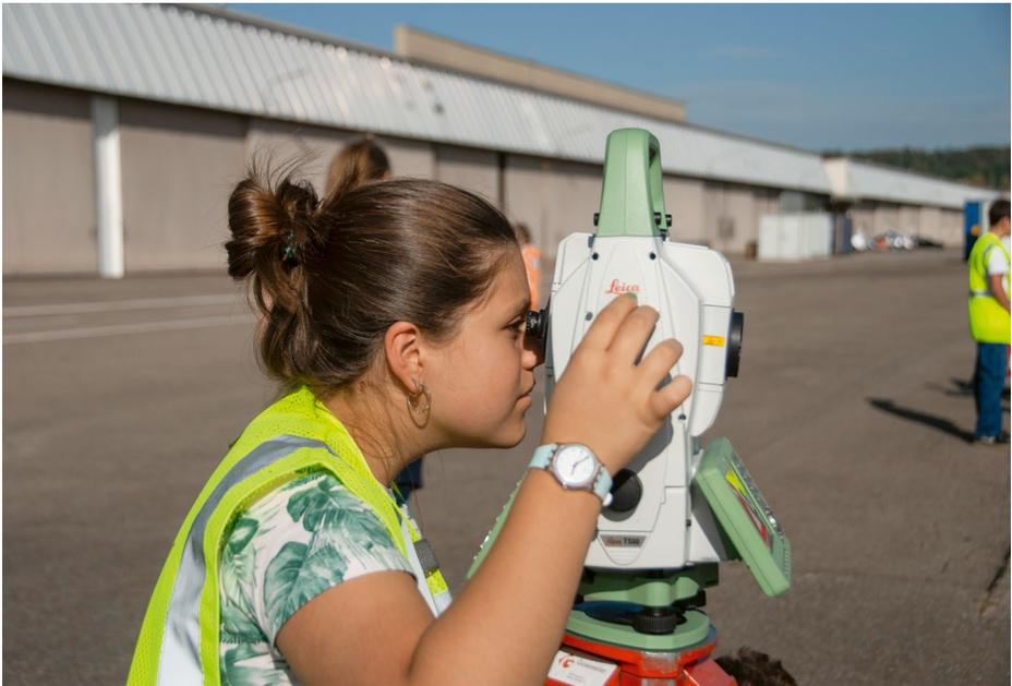
*Mit dem Tachymeter wird die Wurfweite eines Balls gemessen, und zwar auf den Millimeter genau.*
